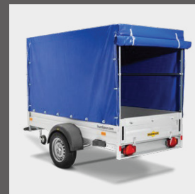
Cerada s konstrukcijom, visina 1000 / 1300 / 1600 / 1800 mm (ovisno o modelu)
