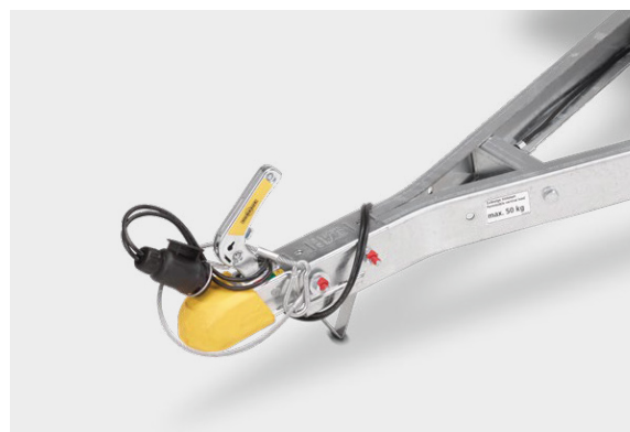
V-vučna ruda, vruće pocinčana, s poprečnim ojačanjem
