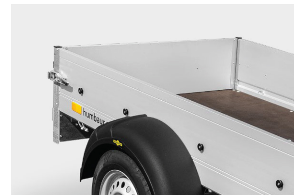
Bočne stranice od eloksiranog aluminijevog profila, dvostruka stijenka
