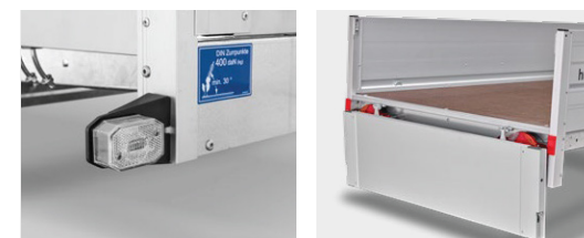
lijevo Prednja pozicijska svjetla desno Stražnja stranica s uvučenim zatvaračima
